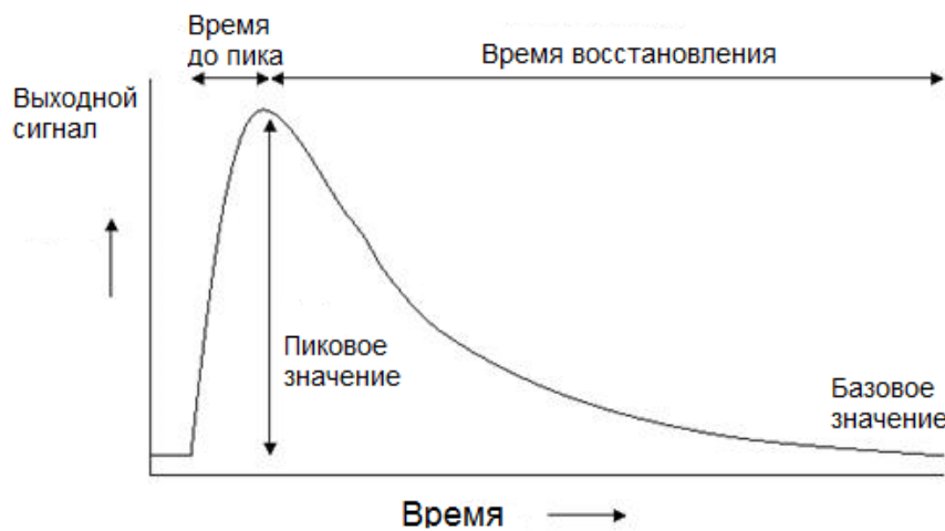
Рисунок 3. Форма изменения сигнала электрохимического датчика
